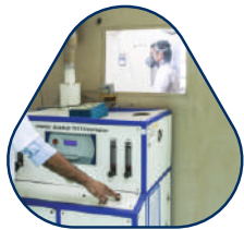
Inward leakage test
